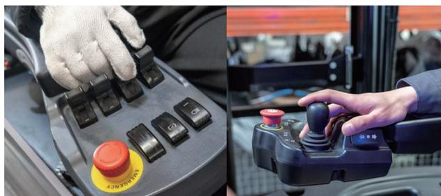
Controles hidráulicos con punta de dedo o joystick
