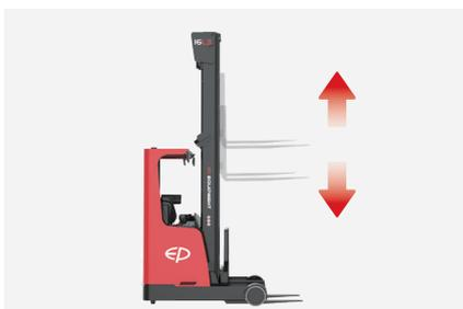
Velocidad máxima de elevación: 0.6 m/s
