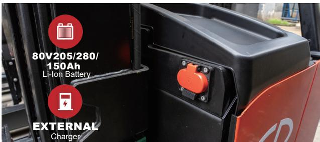
Puerto de carga externo con cubierta protectora
