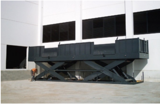
Mesa doble tijera horizontal para superar desniveles
