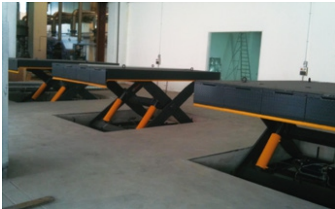
Mesa simple tijera con uñetas para sistemas de producción
